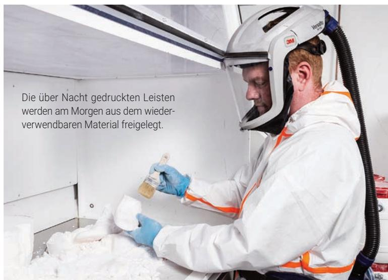
Die über Nacht gedruckten Leisten werden am Morgen aus dem wiederverwendbaren Material freigelegt.
